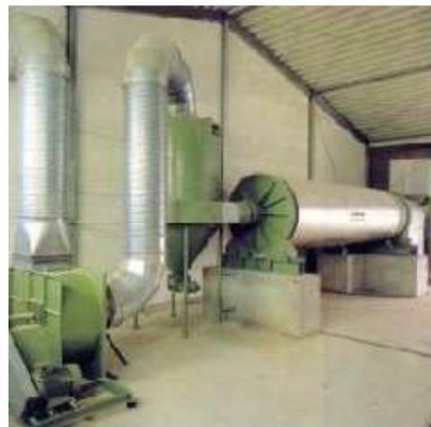
**Abbildung 4-11: Bandtrockner der Firma Binder [Binder, o. J.], Trommeltrockner der Firma Stela [Stela, o. J.]**
