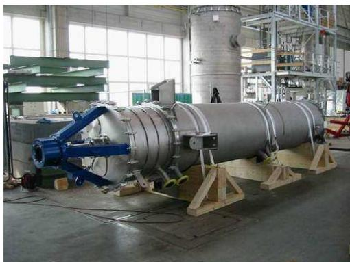
Vorentwässerter Klärschlamm wird von oben in den Trockner eingetragen und mittels Rotor spiralförmig entlang der Heizflächen bis hin zur Austragsseite transportiert. Aufgrund der ständigen Oberflächenenerneuerung und geringen Schlammengen im Trockner sowie kontinuierlicher Durchmischung und der damit verbundenen selbstreinigenden Wirkung kann die kritische Leimphase problemlos durchfahren werden.
