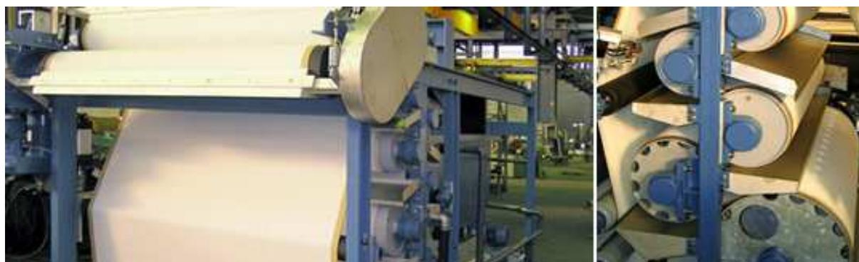
**Abbildung 4-3: Entwässerungsaggregate: a) Dekanter der Firma Huber [Huber, o. J.], b) Kammerfilterpresse der Firma Protec [Protec, o. J.], c) Bandfilterpresse der Firma Passavant [Passavant-Geiger, o. J.]**
