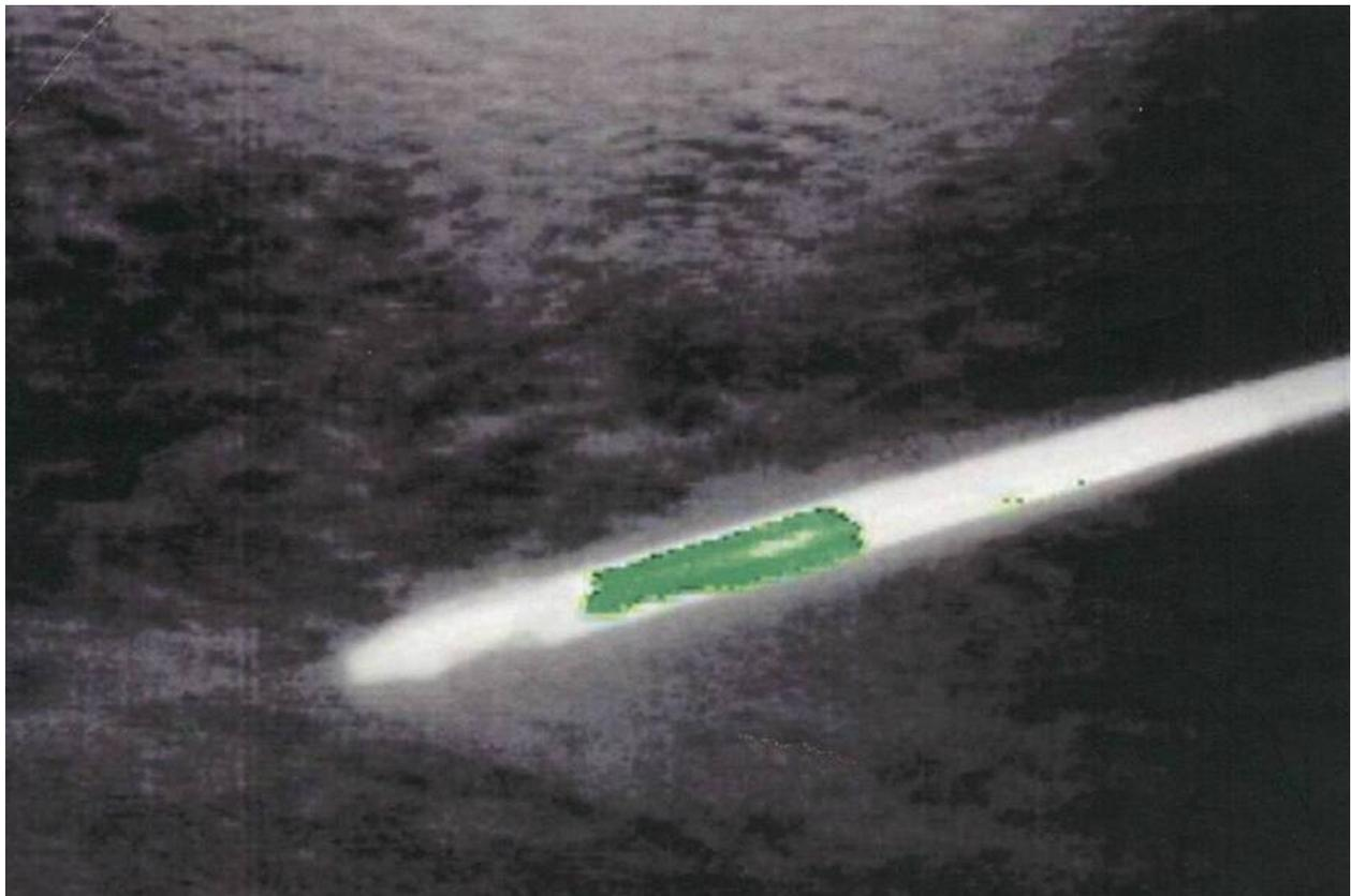
Abbildung 4-5: Wärmebildphoto (Luftaufnahme) des TMS „Waldhof“ am 14.01.2011; Wärmeentwicklung (grün) in den Tanks 6 und 7
