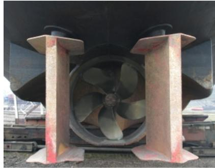
Abbildung 3-68: Ruder und Propeller in Düse
