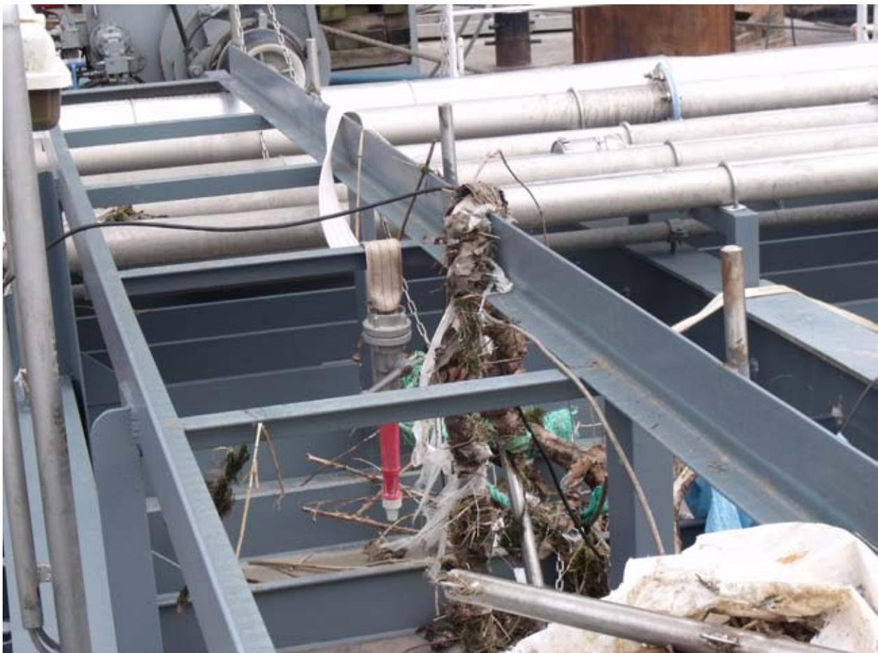
Abbildung 26: Schlauch aus dem Entlüftungsrohr des Ballasttanks 2 - Backbordseite - 14.2.2011
