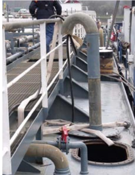
Abbildung 25: Entlüftungsrohr mit Schläuchen Ballasttank 2 - Backbordseite - 14.2.2011
