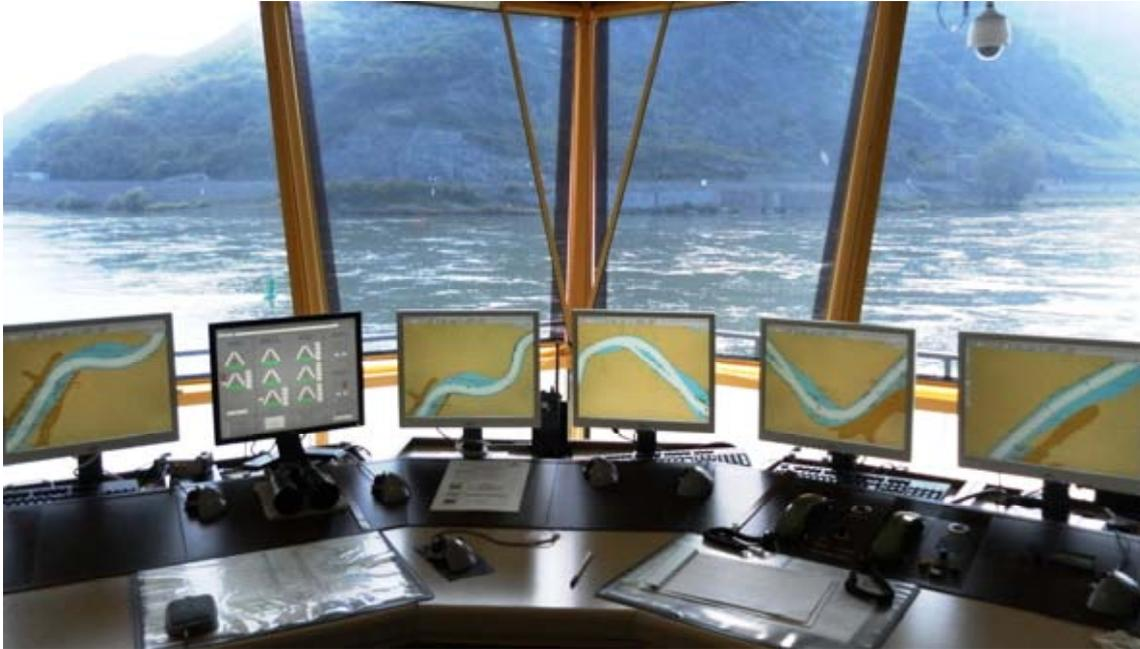
Abbildung 3-3: Darstellung der Verkehrssituation am Arbeitsplatz des Wahrschauers in der Revierzentrale Oberwesel
