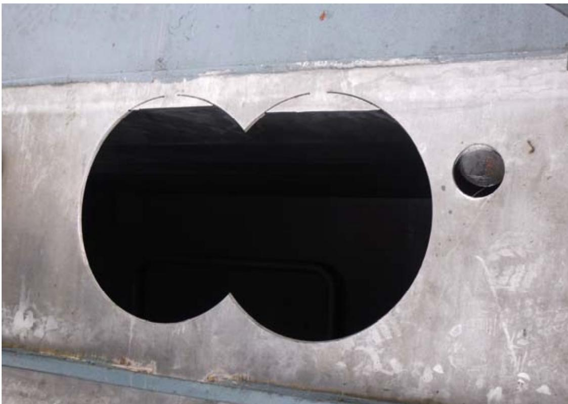
Abbildung 11: Im Zuge der Bergungsmaßnahmen in die Ladetanks geschnittene Öffnungen - 15.2.2011
