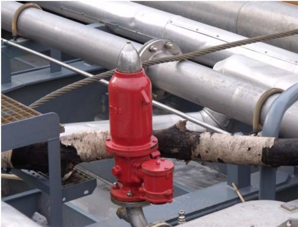
Abbildung 27: Hochgeschwindigkeitsventil HS 2293 an Bord des TMS „Waldhof“ - 14.02.2011
