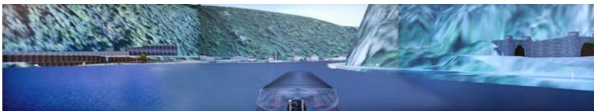
Abbildung 5-55: Sichtmodell des gekenterten und zu Tal treibenden TMS „Waldhof“ bei Rhein-km 554 am Schiffsführungssimulator der BAW
