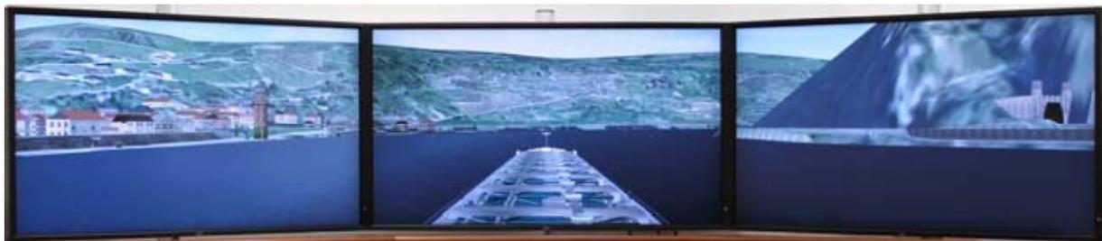
Abbildung 5-3: Geländemodell mit generischen Texturen für eine Simulationsfahrt
