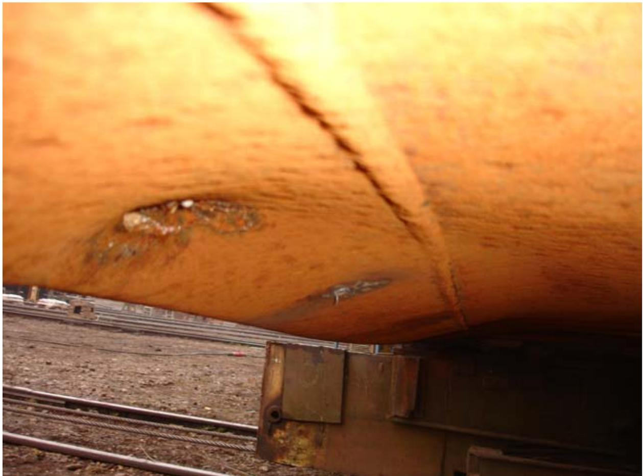
Abbildung 23: die beiden Löcher in der Backbordkimm - 25.2.2011
